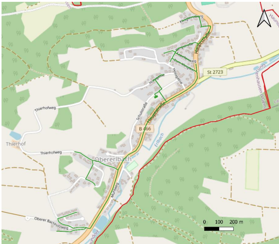
Abbildung 16 Möglicher Wärmenetzverlauf (grün) Obererlbach (vorläufig)
